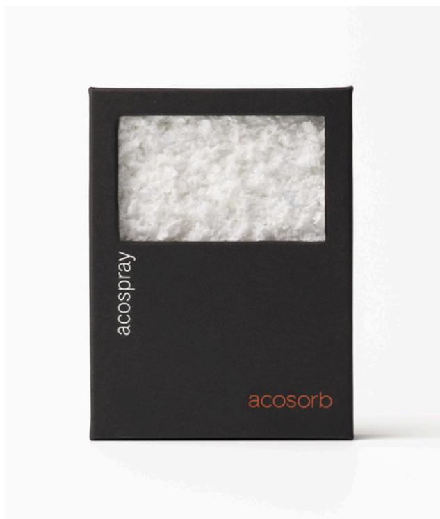
O Acospray DC3 é o nosso gesso spray padrão e consiste em dois componentes: um agente aglutinante e fibras de celulose enriquecidas. O material pode ser aplicado em uma espessura de 10 mm a um máximo de 50 mm. Neste último caso, a absorção máxima das frequências da fala é alcançada.
