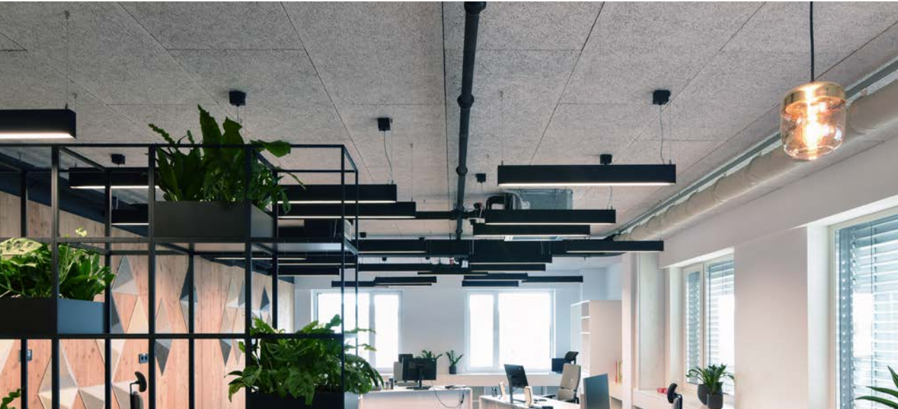
Estrutura em ripado de madeira, perfil de rebordo P0, painel acústico CEWOOD 25 mm.
